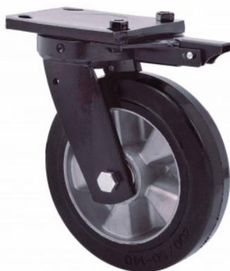
Ruedas con núcleo de aluminio y banda de goma negra elástica con una dureza 70° shore A. Especialmente indicada para soportar altas cargas hasta 500 Kg.
