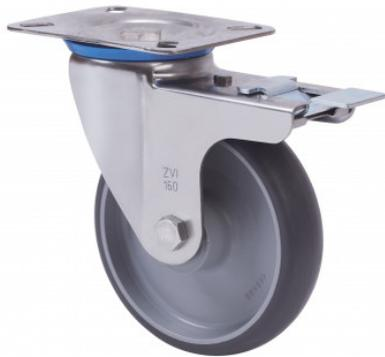
Ruedas de goma gris inyectada con todos sus componentes de acero inoxidable (AISI 304). Especialmente indicada para soportar cargas hasta 180 Kg.
