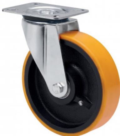
Ruedas con núcleo de acero y banda de poliuretano fundido con dureza de 95° shore A, especialmente indicada para soportar altas cargas hasta 700 Kg.
