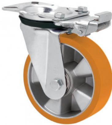
Ruedas con núcleo de aluminio y banda de poliuretano fundido de dureza 95° shoreA. Especialmente indicada para soportar cargas hasta 700 Kg.
