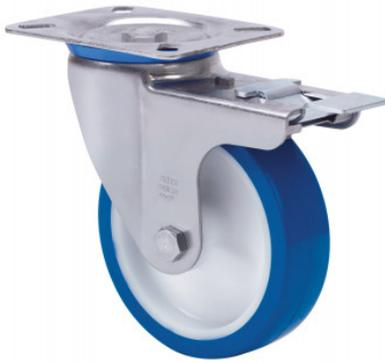
Ruedas con núcleo de poliamix blanco y banda de poliuretano azul inyectado blando de dureza 80° shore A. Especialmente indicada para soportar cargas hasta 250 Kg.
