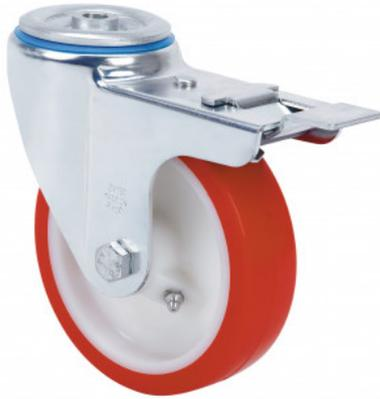
Ruedas con núcleo de nylon blanco y banda de poliuretano rojo inyectado de dureza 90-95° shoreA. Especialmente indicada para soportar cargas hasta 400 Kg.
