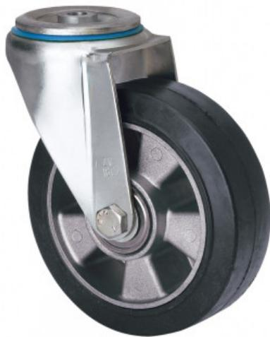
Ruedas de núcleo de aluminio con banda de goma negra elástica con una dureza 70° shore A. Especialmente indicada para soportar cargas hasta 400 Kg.
