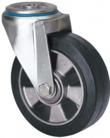
Ruedas de núcleo de aluminio con banda de goma negra elástica con una dureza 70° shore A. Especialmente indicada para soportar cargas hasta 400 Kg.
