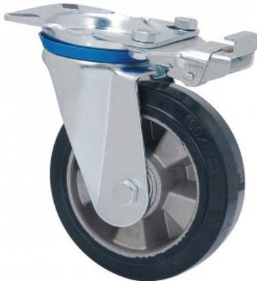
Ruedas de núcleo de aluminio con banda de goma negra elástica con una dureza 70° shore A. Especialmente indicada para soportar cargas hasta 400 Kg.
