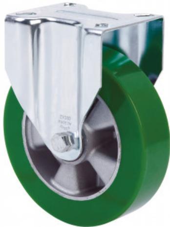
Ruedas con núcleo de aluminio y banda de poliuretano verde de dureza 80° shoreA. Especialmente indicada para soportar cargas hasta 400 Kg.
