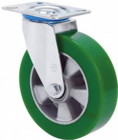
Ruedas con núcleo de aluminio y banda de poliuretano verde de dureza 80° shoreA. Especialmente indicada para soportar cargas hasta 400 Kg.
