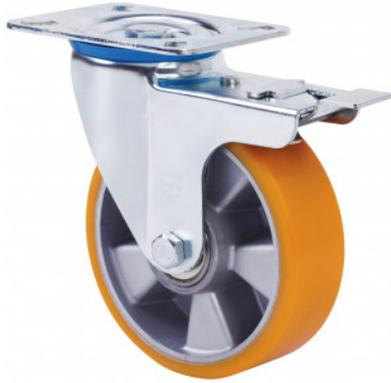
Ruedas con núcleo de aluminio y banda de poliuretano fundido de dureza 95° shoreA. Especialmente indicada para soportar cargas hasta 400 Kg.
