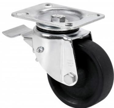
Ruedas de resina, especialmente indicada para soportar altas temperaturas de hasta 300° y cargas hasta 125 Kg.
