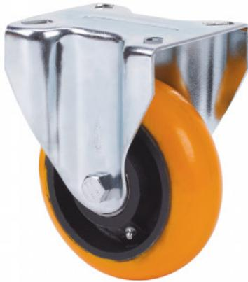
Ruedas con núcleo de acero y banda de poliuretano fundido con dureza de 95° shore A con banda de rodadura en forma balona, especialmente indicada para soportar altas cargas hasta 800 Kg.
