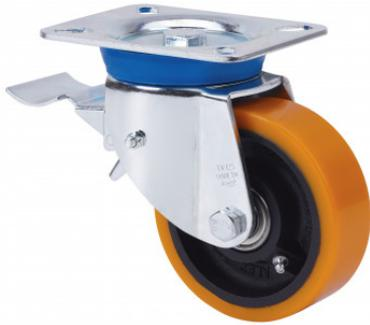
Ruedas con núcleo de acero y banda de poliuretano fundido con dureza de 95° shore A, especialmente indicada para soportar altas cargas hasta 800 Kg.
