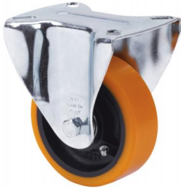
Ruedas con núcleo de acero y banda de poliuretano fundido con dureza de 95° shore A, especialmente indicada para soportar altas cargas hasta 800 Kg.
