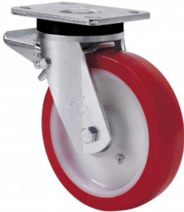
Ruedas con núcleo de nylon blanco y banda de poliuretano rojo dureza 90-95° shore A. Especialmente indicada para soportar altas cargas de hasta 600 Kg.
