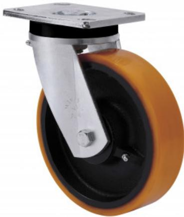
Ruedas con núcleo de acero y banda de poliuretano fundido con dureza de 95° shore A, especialmente indicada para soportar altas cargas hasta 1.000 Kg.
