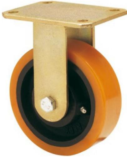
Ruedas con núcleo de acero y banda de poliuretano fundido con dureza de 95° shore A, especialmente indicada para soportar altas cargas hasta 600 Kg.
