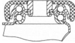
Fabricada con chapa de acero hasta 2 m/m de espesor. Soporte con doble rodamiento a bolas. Acabado cincado. Especialmente diseñada para: Carros de Supermercado. Fabricadas según normas europeas EN 12530.
