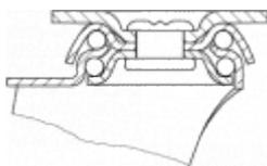
Fabricada con chapa de acero de hasta 2,5 m/m de espesor.
