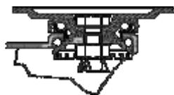
Fabricada con chapa de acero hasta 2,5 m/m de espesor. Soporte con doble rodamiento a bolas con pistas complementarias endurecidas. Acabado cincado cromado. Gran variedad de fijaciones, frenos, ruedas. Fabricadas según normas europeas EN 12530.
