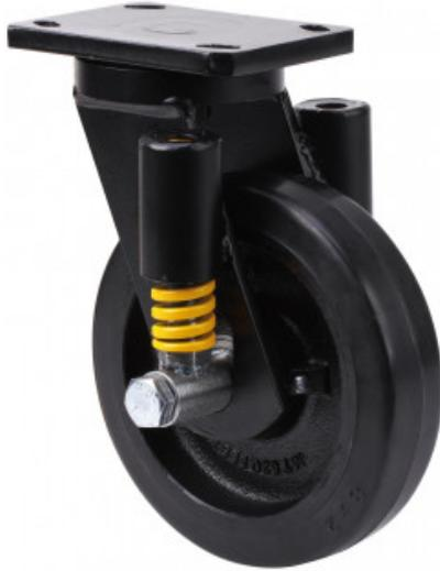
Ruedas con núcleo de acero y banda de goma negra natura. Especialmente indicada para soportar altas cargas de hasta 700 Kg. Con soporte de suspensión elástica mediante incorporación de muelle muy resistente, ideal en suelos irregulares donde su amortiguación actúa.
