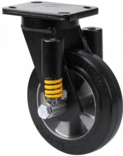
Ruedas de núcleo de aluminio con banda de goma negra elástica con una dureza 70° shore A. Especialmente indicada para soportar altas cargas hasta 500 Kg. Con soporte de suspensión elástica mediante incorporación de muelle muy resistente, ideal en suelos irregulares donde su amortiguación actúa.
