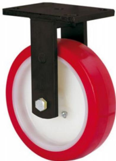
Ruedas con núcleo de nylon blanco y banda de poliuretano rojo dureza 90-95° shore A. Tracción mecánica. Especialmente indicada para soportar altas cargas de hasta 600 Kg.
