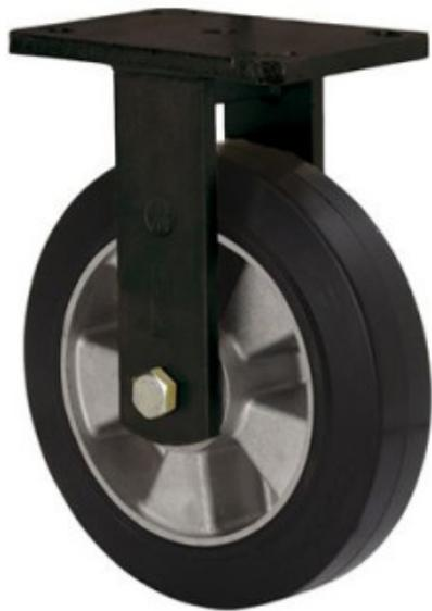
Ruedas con núcleo de aluminio y banda de goma negra elástica con una dureza 70° shore A. Especialmente indicada para soportar altas cargas hasta 500 Kg.
