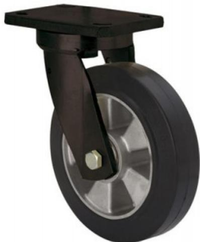
Ruedas con núcleo de aluminio y banda de goma negra elástica con una dureza 70° shore A. Especialmente indicada para soportar altas cargas hasta 500 Kg.
