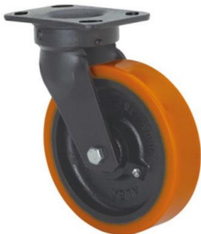
Ruedas con núcleo de acero y banda de poliuretano fundido con dureza de 95° shore A, especialmente indicada para soportar altas cargas hasta 1.250 Kg.
