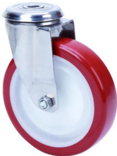
Ruedas de poliuretano inyectado con todos sus componentes de acero inoxidable (AISI 304). Especialmente indicada para soportar cargas hasta 300 Kg.
