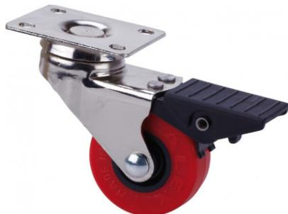
Ruedas rojas de poliuretano inyectado blando especialmente indicado para soportar cargas hasta 40 Kg.
