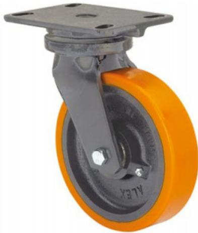
Ruedas con núcleo de acero y banda de poliuretano fundido con dureza de 95° shore A, especialmente indicada para soportar altas cargas hasta 1.270 Kg.
