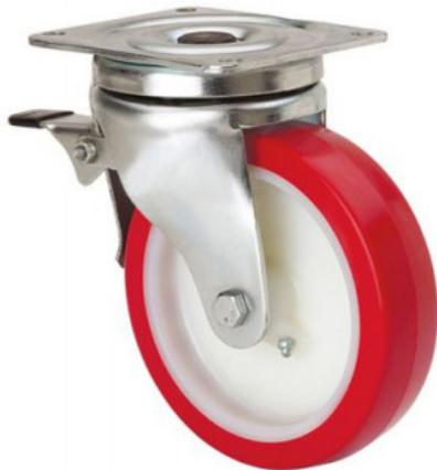
Ruedas con núcleo de nylon blanco y banda de poliuretano rojo dureza 90-95° shore A. Especialmente indicada para soportar altas cargas de hasta 600 Kg.
