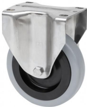
Ruedas de goma negra natural con todos sus componentes de acero inoxidable (AISI 304). Especialmente indicada para soportar cargas hasta 135 Kg.
